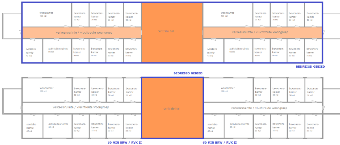
Figuur 3 – Voorbeeld centrale hal als brandruimte
