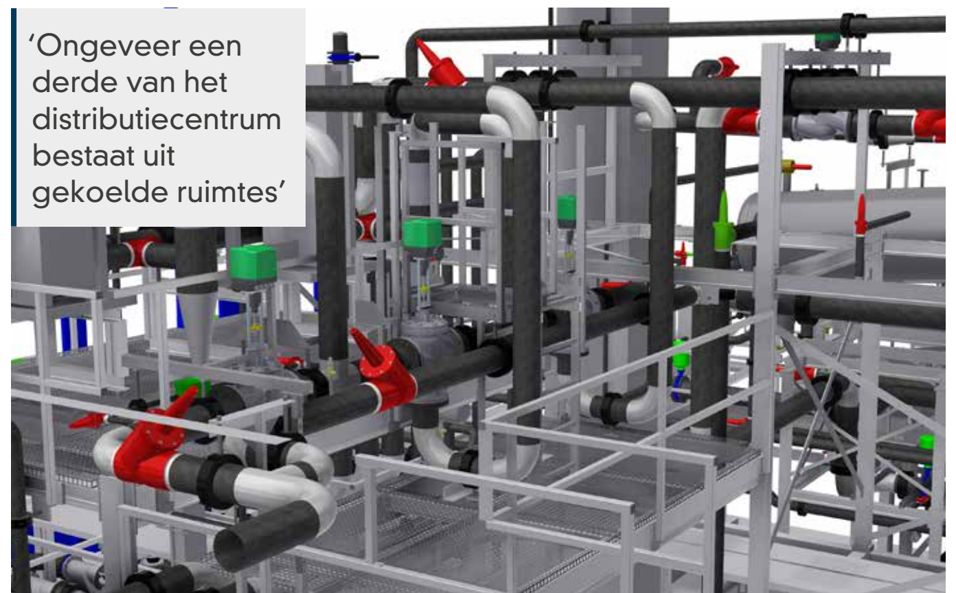
De verwarming en koeling van het dc gebeurt zoveel mogelijk met restwarmte en koude uit de koelinstallatie van Voets & Donkers. Het ontwerp van de koelinstallatie is conform het concept-huisontwerp van Lidl uitgevoerd.
