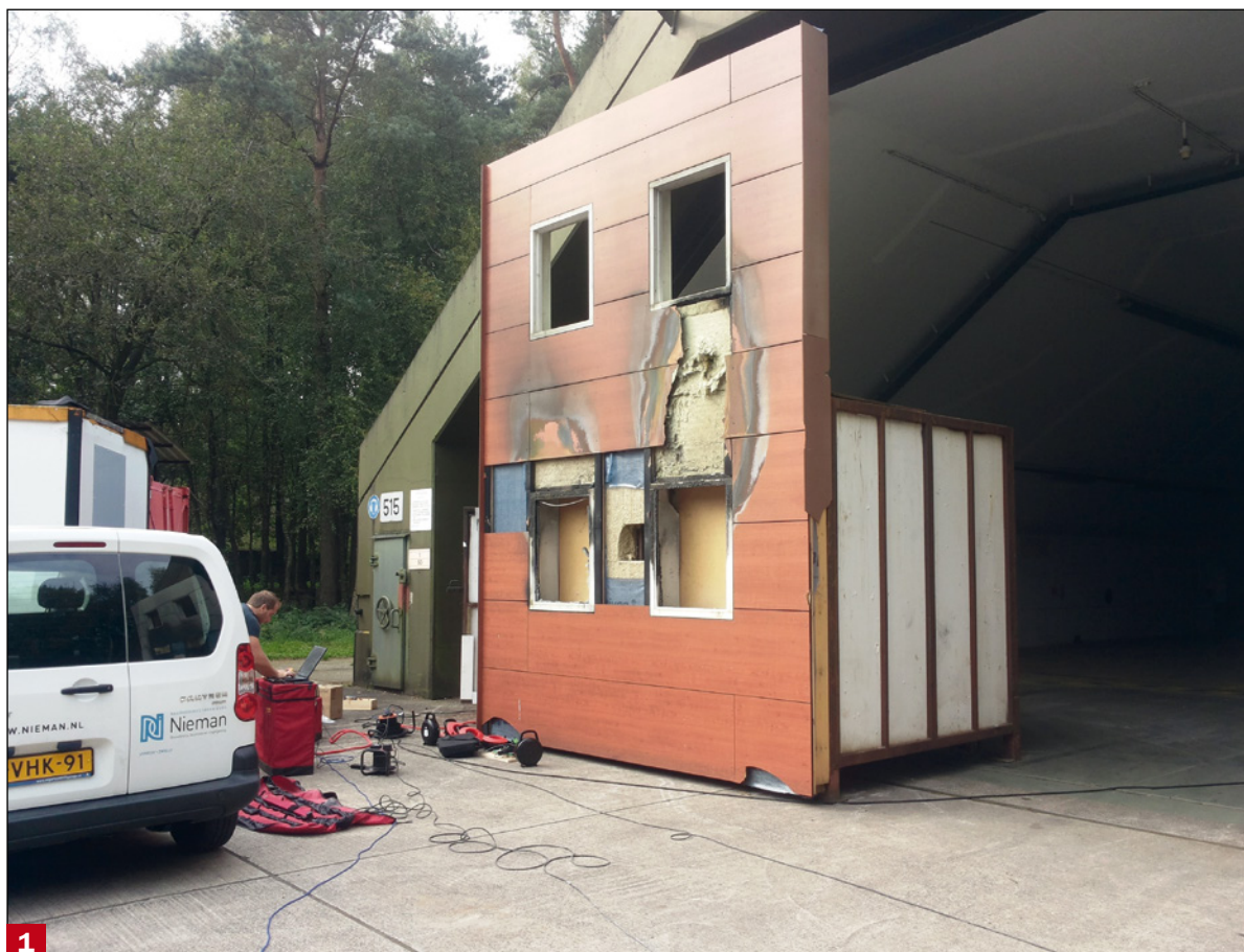
Beeld van de meetopstelling (zeecontainer). De openingen in de gevel zijn dichtgezet
