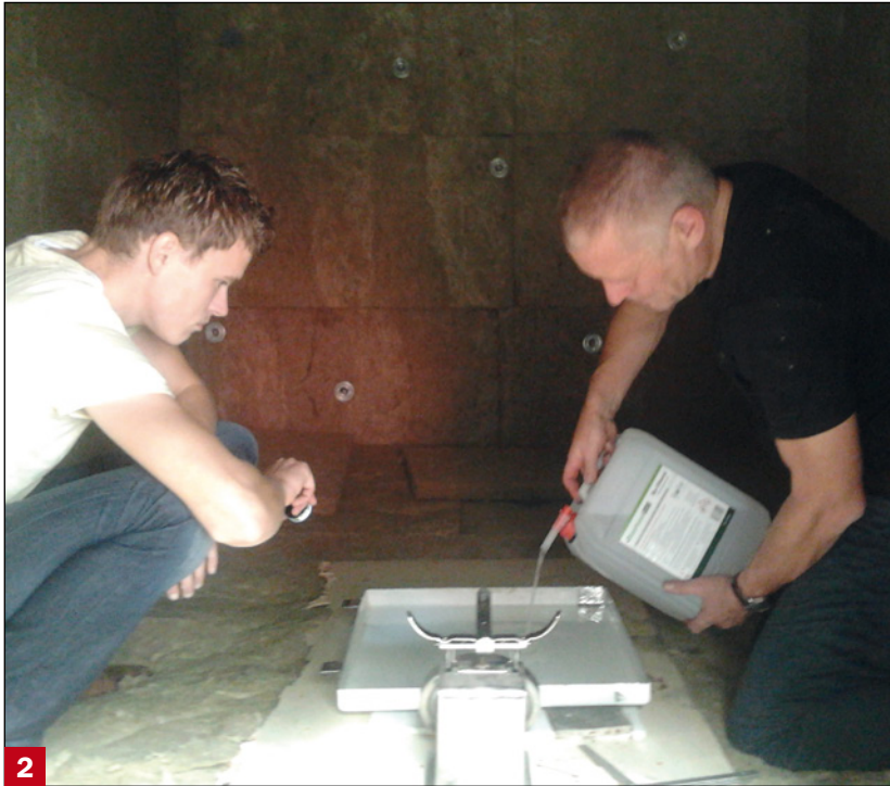
Vullen van de ethanol brandopstelling in de geïsoleerde zeecontainer
