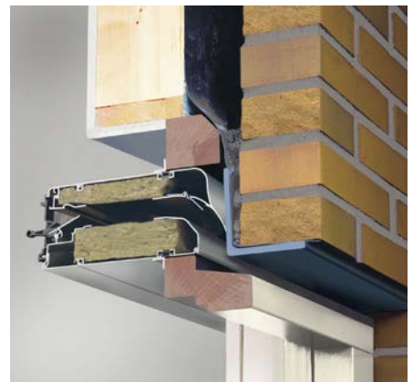
Weggewerkte zelfregelende suskast voor zwaar geluidbelaste gevel.
