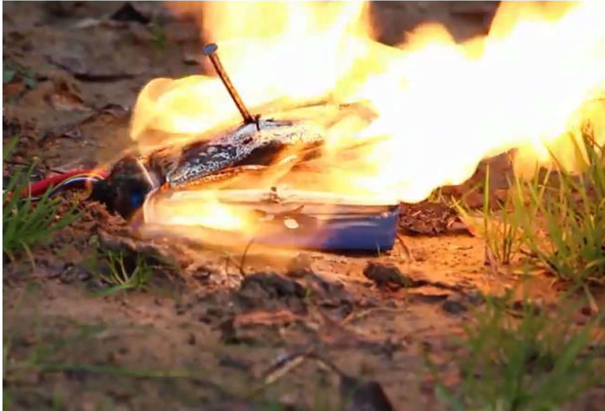
Figuur: Brand ten gevolge van mechanische beschadiging in een kleine Lithium-Ion accu
