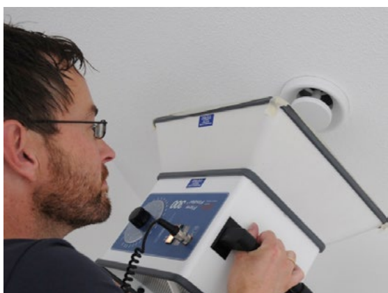
Als onderdeel van de ventilatieprestatiekeuring wordt het ventilatiedebiet van ieder afvoerpunt gemeten.
