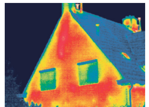
Resultaat van meting van de isolatie van de schil met een infrarood camera.
