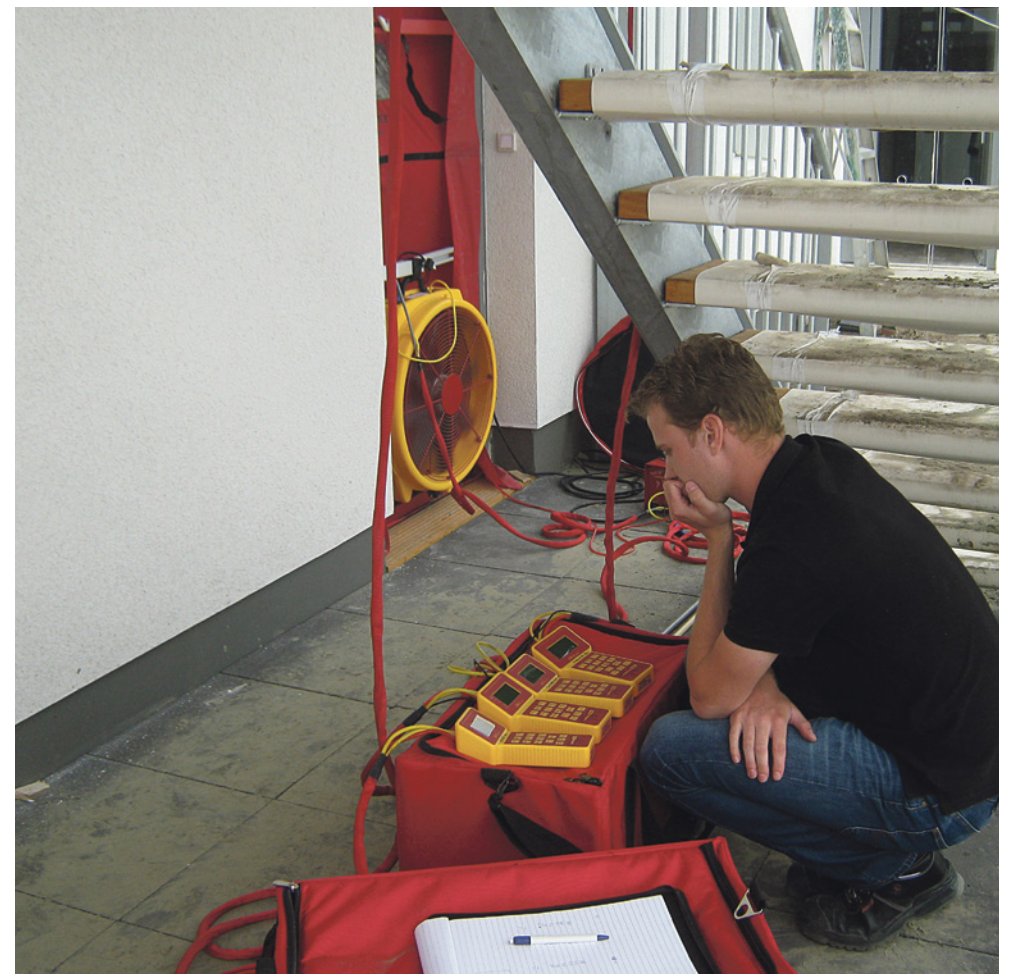
Meting luchtdichtheid door de 'blower door test'. Foto: Adviesburo Nieman.
