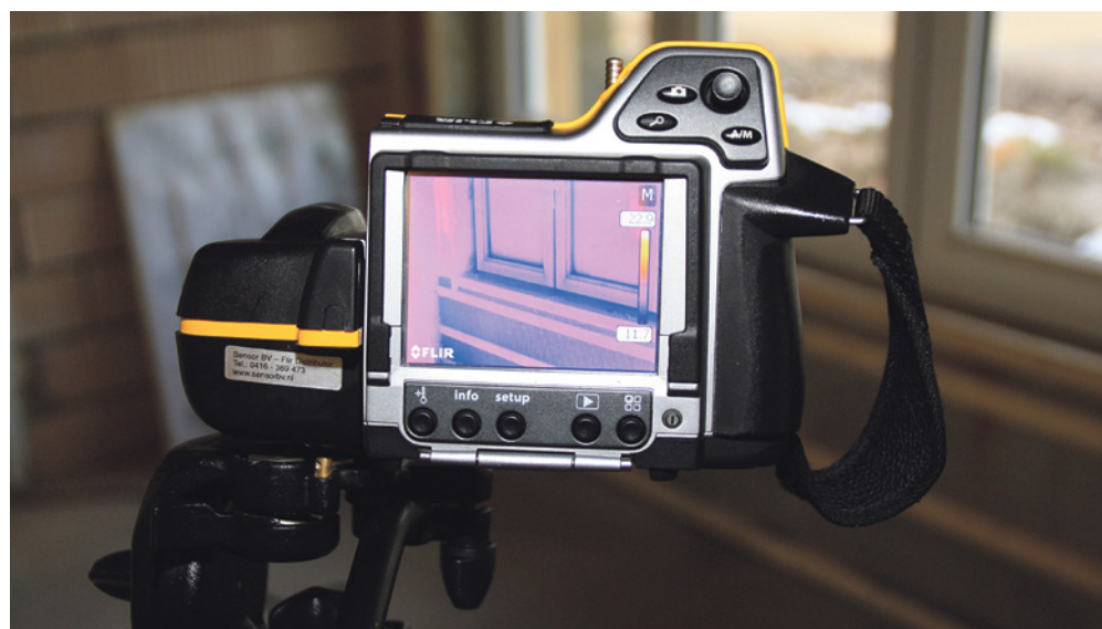
Thermografische opname van de binnenzijde van de woning.
