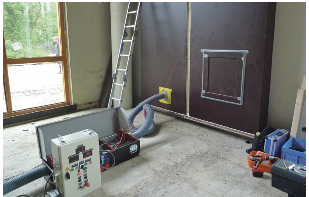
Test van de luchtdichtheid van een bouwdeel in het laboratorium.
