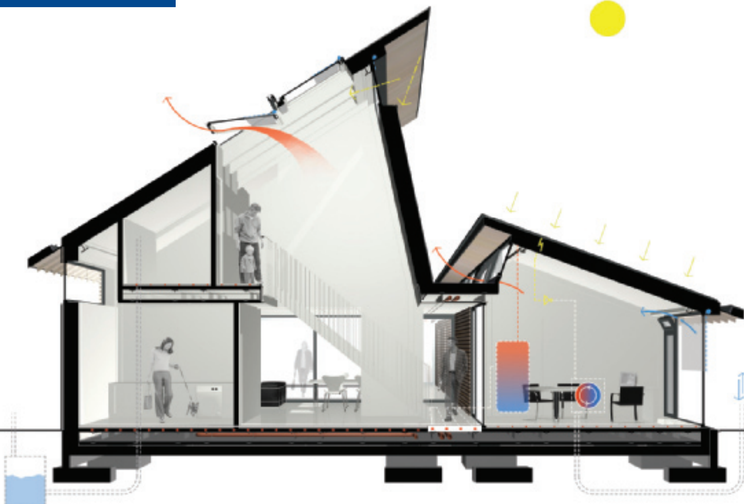
HoTT House, Sterksel: Geautomatiseerde, intelligente controle van dakvensters voor ventilatie in lente, zomer en herfst (beeld: KAW/e Architecten en Adviseurs)
