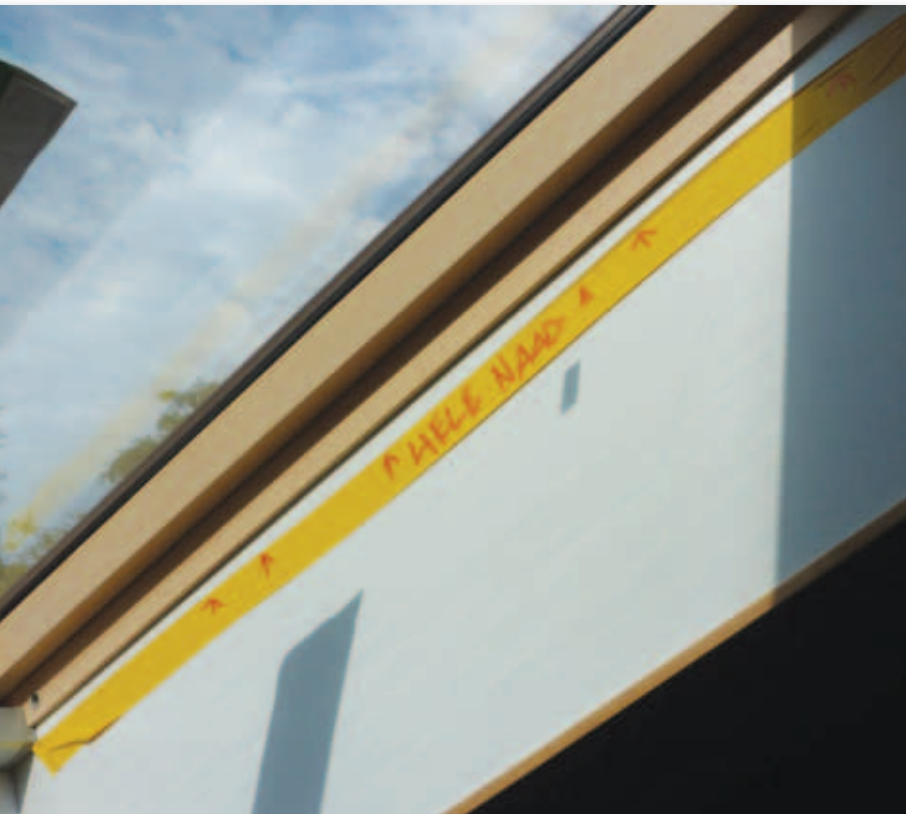
Aanduiding luchtlekken tijdens luchtdichtheidsmeting.
