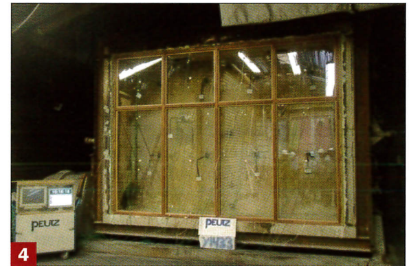
4 Meetopstelling dubbel glas
