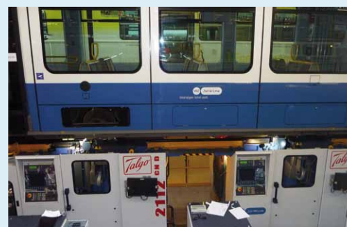
Voorbeeld van een kuitwieldraaibank. (bron: Talgo, Spanje)
