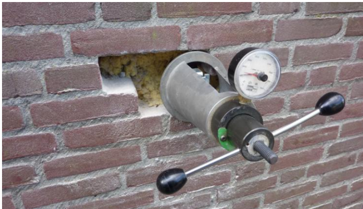
Analyse en destructief onderzoek kopgevels, ankertrekproef, Heemstede.
