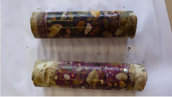
Analyse en destructief onderzoek betonnen balkons, controle betoncarbonatatie, Lelystad.
