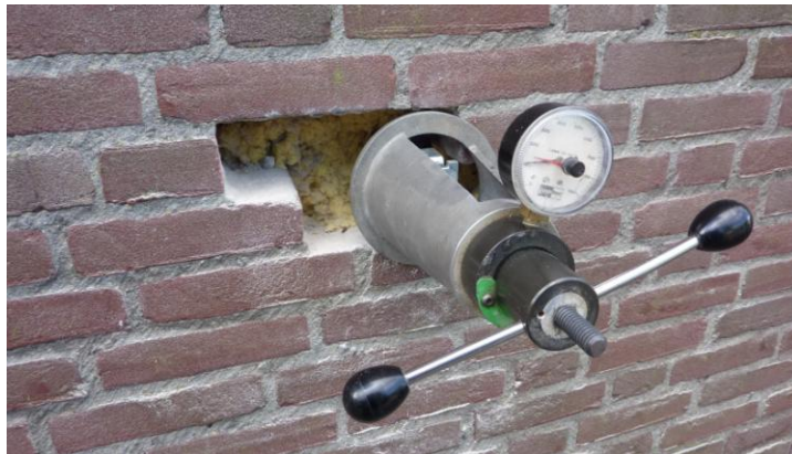
Analyse en destructief onderzoek kopgevels, ankertrekproef, Heemstede.
