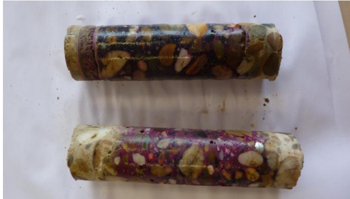
Analyse en destructief onderzoek betonnen balkons, controle betoncarbonatie, Lelystad
