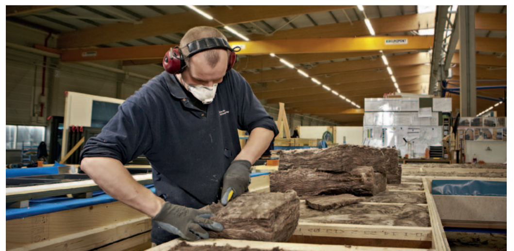
Productie gevelelementen bij De Groot Vroomshoop Houtbouw. De arbeids- en milieuvriendelijke Knauf glaswol wordt enigszins op overmaat gesneden en kierdicht in de wanden aangebracht.
