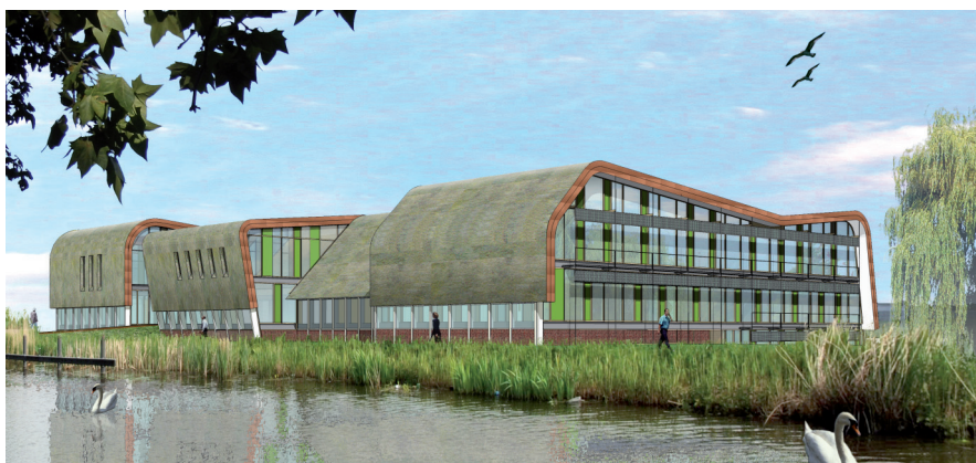
Figuur A 6010-2 Gemeentehuis Midden-Delfland, ontworpen door Inbo Rijswijk en gereed medio 2012. In dit project wordt riet zowel in de gevel en op het dak toegepast. Hierdoor spelen zowel risico's op het gebied van damptransport en vervuiling als op het gebied van brandveiligheid
