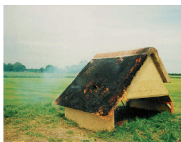
Figuur A 6010-11a en b Brandproeven Arnhem niet-geïmpregneerd rieten schroefdak. Brandproef met vuurkorf. Het riet smeult vooral en geeft zeer kleine vlammen met een beperkte straling. Bron foto's: Vakfederatie rietdekkers. Een verslag van de gehele brandproef is te zien op de website van de Vakfederatie voor Rietdekkers: www.riet.com
