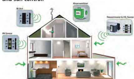
Ventilatiesysteem met CO 2 - en vochtsensor. Hier worden ook de gevelroosters aangestuurd, dat is niet strikt noodzakelijk. Bron: Duco ventilation and sun control.
