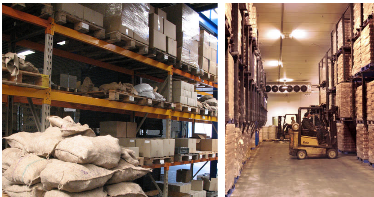
Figuur 1: Twee opslaghallen van ongeveer gelijke grootte en met eenzelfde vuurlast. In het ene geval vindt de opslag plaats bij omgevingstemperatuur (links: +20 °C), in het andere geval gaat het om een vriesveem (rechts: -20 °C).
