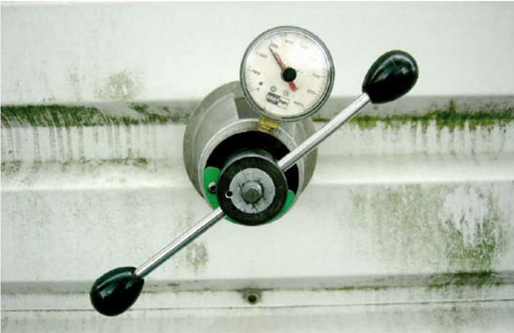
Tijdens het onderzoek is door middel van uittrekprouwen de kwaliteit van meer dan 20 jaar oude bevestigingsmiddelen beoordeeld. De resultaten hiervan waren in het algemeen positief.
